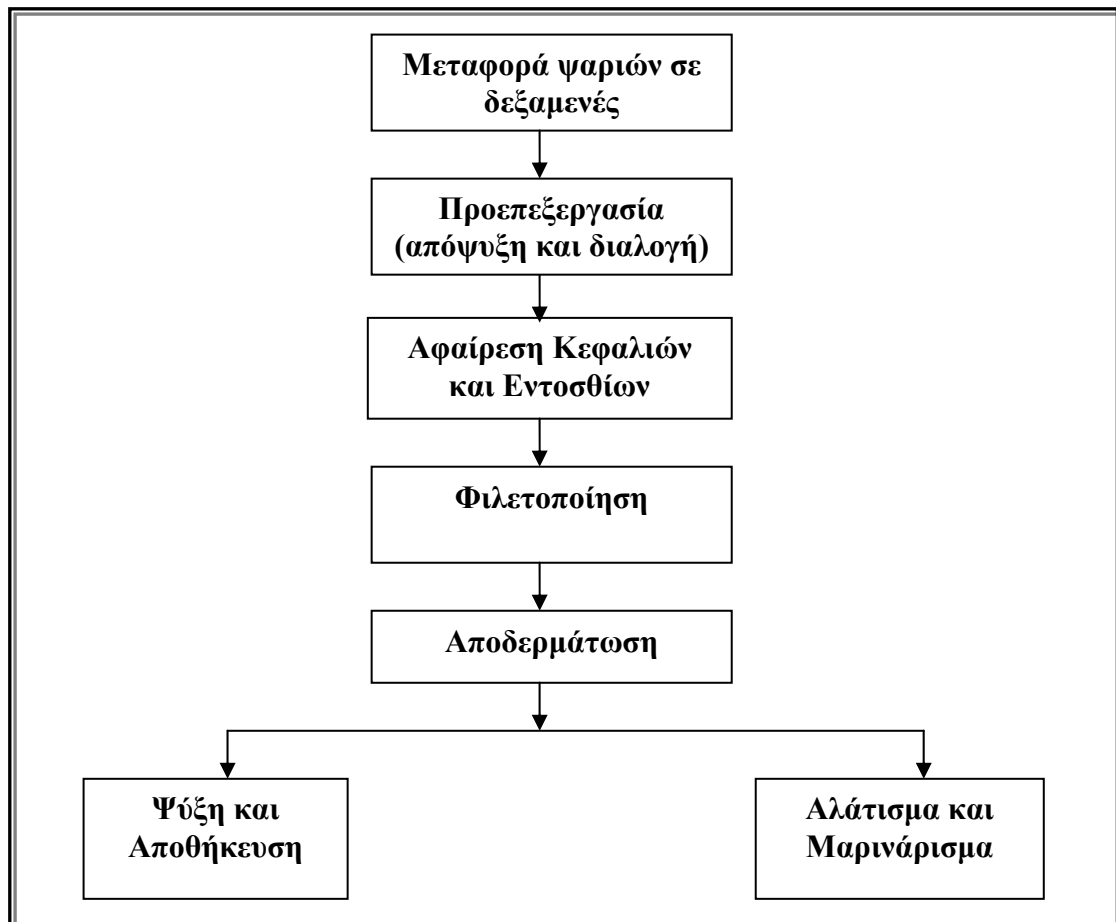
Σχήμα 1: Διάγραμμα ροής των διαδικασιών παραγωγής στην συγκεκριμένη μονάδα επεξεργασίας ψαριών
