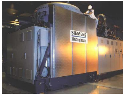
Υβριδική μονάδα 220 KW της Siemens-Westinghouse που συνδυάζει κυψέλες καυσίμου τεχνολογίας SOFC και αεριοστρόβιλο. Είναι η πρώτη του είδους της στον κόσμο.
